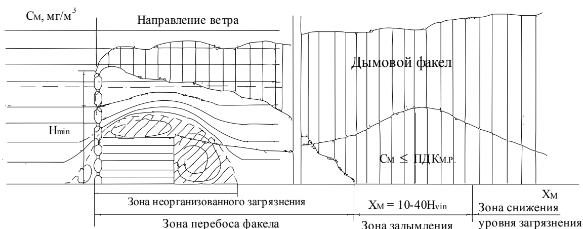
Рис. 4.2. Изменение приземной концентрации примеси в атмосфере от организованного высокого источника выброса.
